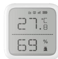
Беспроводной датчик температуры и влажности
