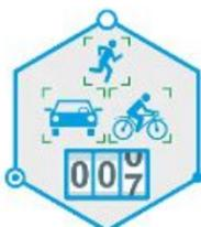
Подсчет объектов, входящих или покидающих охраняемую зону с возможностью разделения их на категории. Генерация тревоги при превышении допустимого значения
